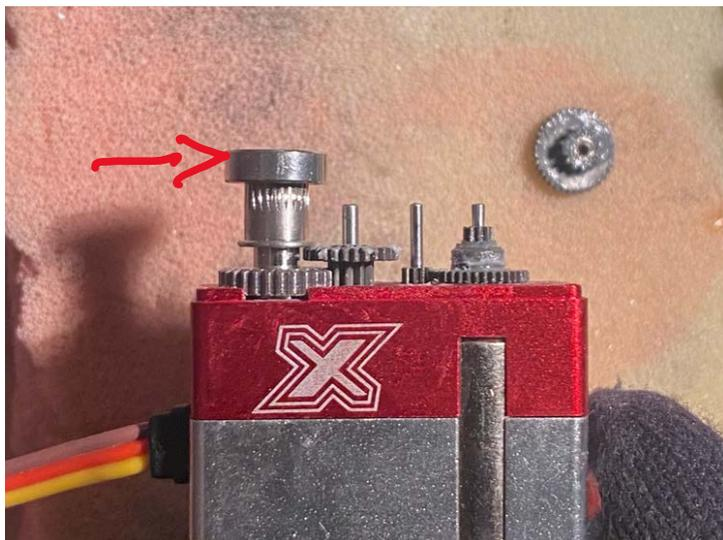
Nun wird das neue Lager von oben aufgeschoben.
