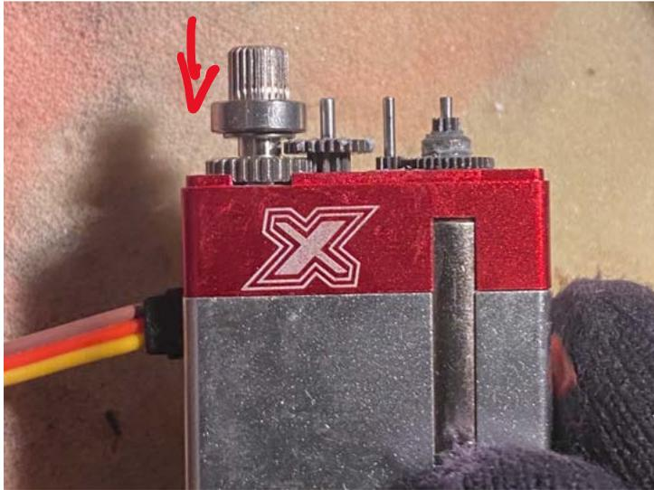
Es wird von oben über das Antriebsritzel bis es auf einer Nut zum liegen kommt nach unten geschoben.
