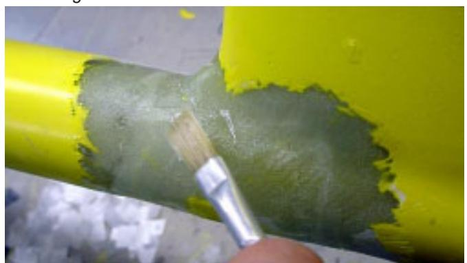
Diese „Plätzli“ werden nun mit Epoxydharz (kein 5-Min. Epoxy verwenden!) Stück um Stück aufgetragen, bis die aus-
