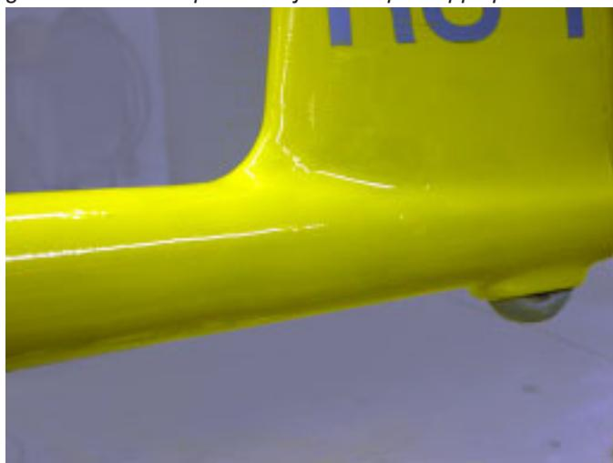
Die fertige Reparaturstelle kann sich sehen lassen. Die Reparatur dauert durch die Härtezeit des Harzes bedingt etwa zwei Abende. Die einfache Spritzpistole funktioniert nur, wenn die Luft (ca. 1,5 - 2 bar) aus einem Kompressor geliefert wird! (die kleinen Druckluftflaschen werden sofort sehr kalt und dann kommt keine Luft mehr!).
