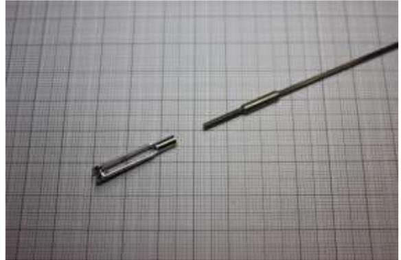
Nach dem Einschieben CFK-Stäbe von der Heckseite her, kann die passende Gestängelänge ermittelt werden.
