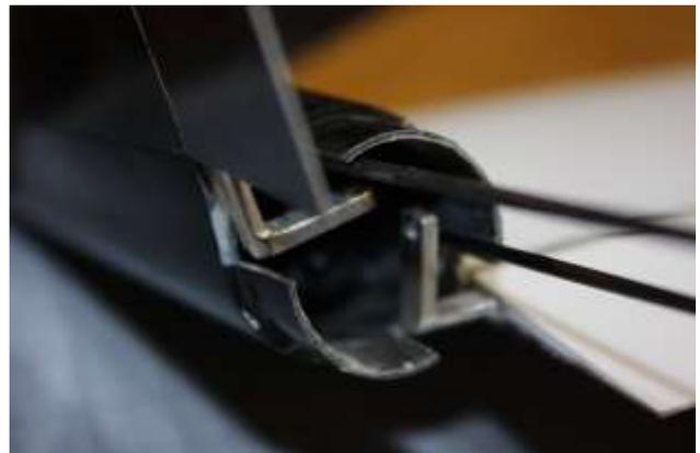
Die CFK-Gestänge werden erst nach dem Einbau des Ballastrohres fertig montiert.
