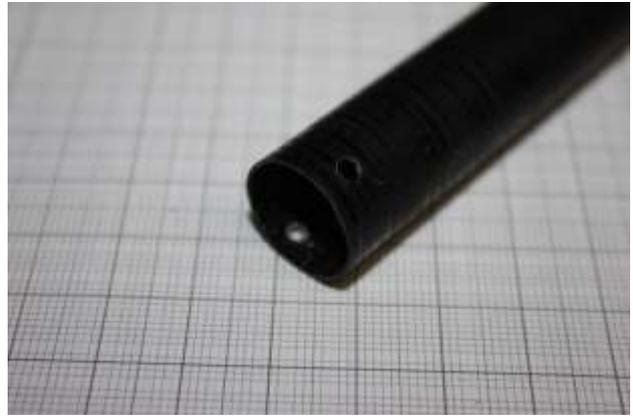
Auf der Rumpfunterseite in der Mitte des Rumpfs ein Loch  $\varnothing$  3 mm bohren. Der Lochabstand beträgt von der Vorderkante der Ballastrohr-Stütze 210 mm. (s. Skizze)
