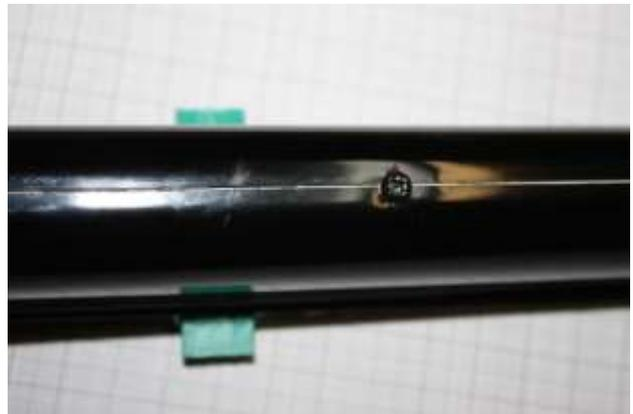
Vorne wird das Ballastrohr mit einer Schraube  $\varnothing$  1,5mm durch die obere Rohröffnung mit der Stütze verschraubt.
