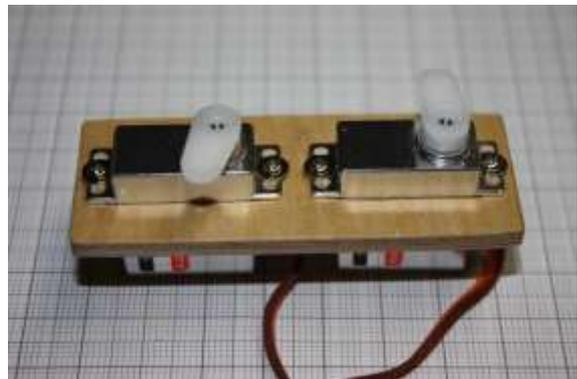
Die Innenflächen wo das Servobrett und die Ballaststütze im Rumpf eingeleimt werden, zuvor anschleifen, damit die Epoxi Leimverbindung bestmöglich hält.
